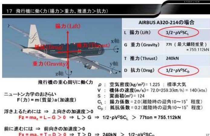
機体が浮き上がるためには、上向きの力  $L$  (揚力) が重力  $G$  よりも大きければよく、前向きに進むためには、前向きの力  $T$  (推力) が抵抗(抗力)  $D$  よりも大きければよい。
